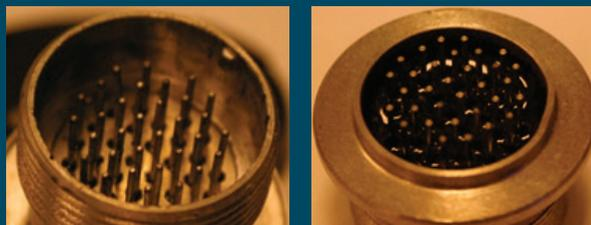
Пример электрического соединителя. Сопротивление изоляции не менее 100 МОм.
